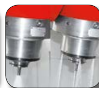
Chłodzenie narz. płynem zewnętrzne + wewnętrzne
