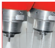
Chłodzenie narzędzia płynem zewnętrznym + wewnętrznym
