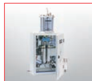
Mikro smarowanie mgłą olejową - wewnętrzną, zewnętrzną
